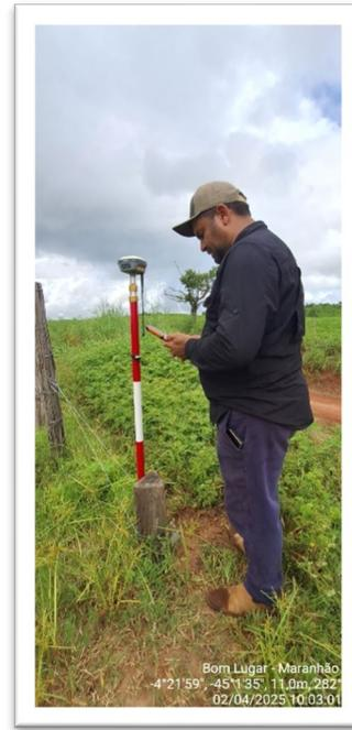
**Fig. 4 e 5:** Medição e implementação de marco físico.
