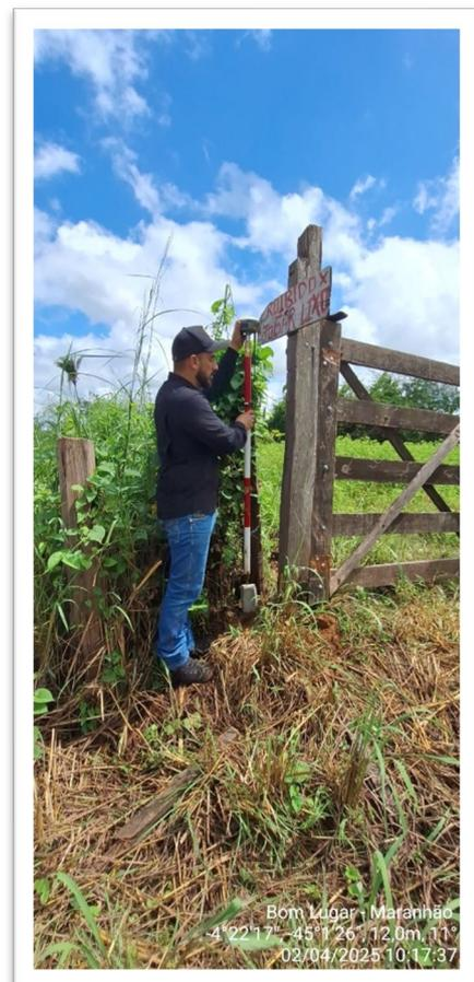
**Fig. 6 e 7:** Medição e implementação de marco físico.
